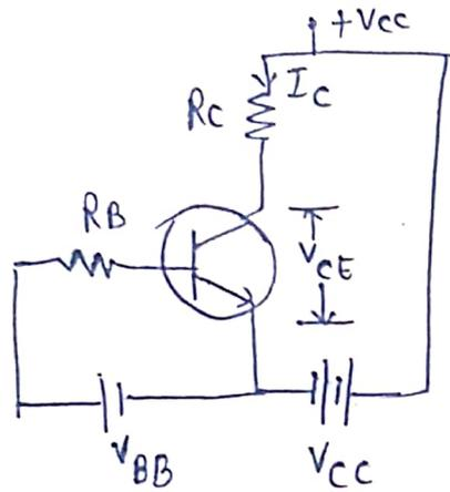
Apply KVL :  $V_{CC} - I_C R_C - V_{CE} = 0$
